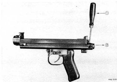
Abb. 52: MG 81; Abnehmen der Sicherungsscheibe
