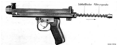
Abb. 54: MG 81; Herausnehmen des Führungsrohres und der Schließfeder
