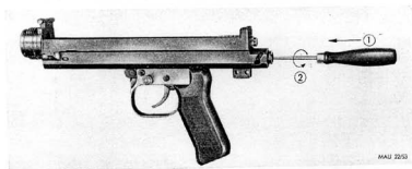
Abb. 53: MG 81; Lösen des Führungsrohres aus seinem Bajonettverschluß
