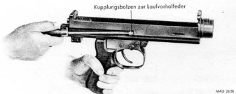
Abb. 58: MG 81; Ausrasten des Kupplungsbolzens
