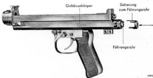
Abb. 57: MG 81; Einsetzen des Führungsrohres mit Schließfeder und Sicherung zum Führungsrohr in den Gehäusekörper
