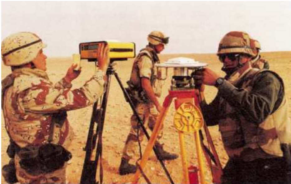
GPS-NAVSTAR À gauche (jaune) récepteur TRIMBLE ; à droite antenne ASHTECH
