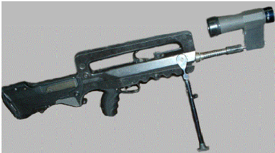
Fig. 1 Dispositif optique de réglage monté sur le FAMAS 5,56 Mle F1
