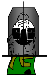
Fig. 17 – principe de pointage avec le cran de mire et le coulisseau du tir de nuit
