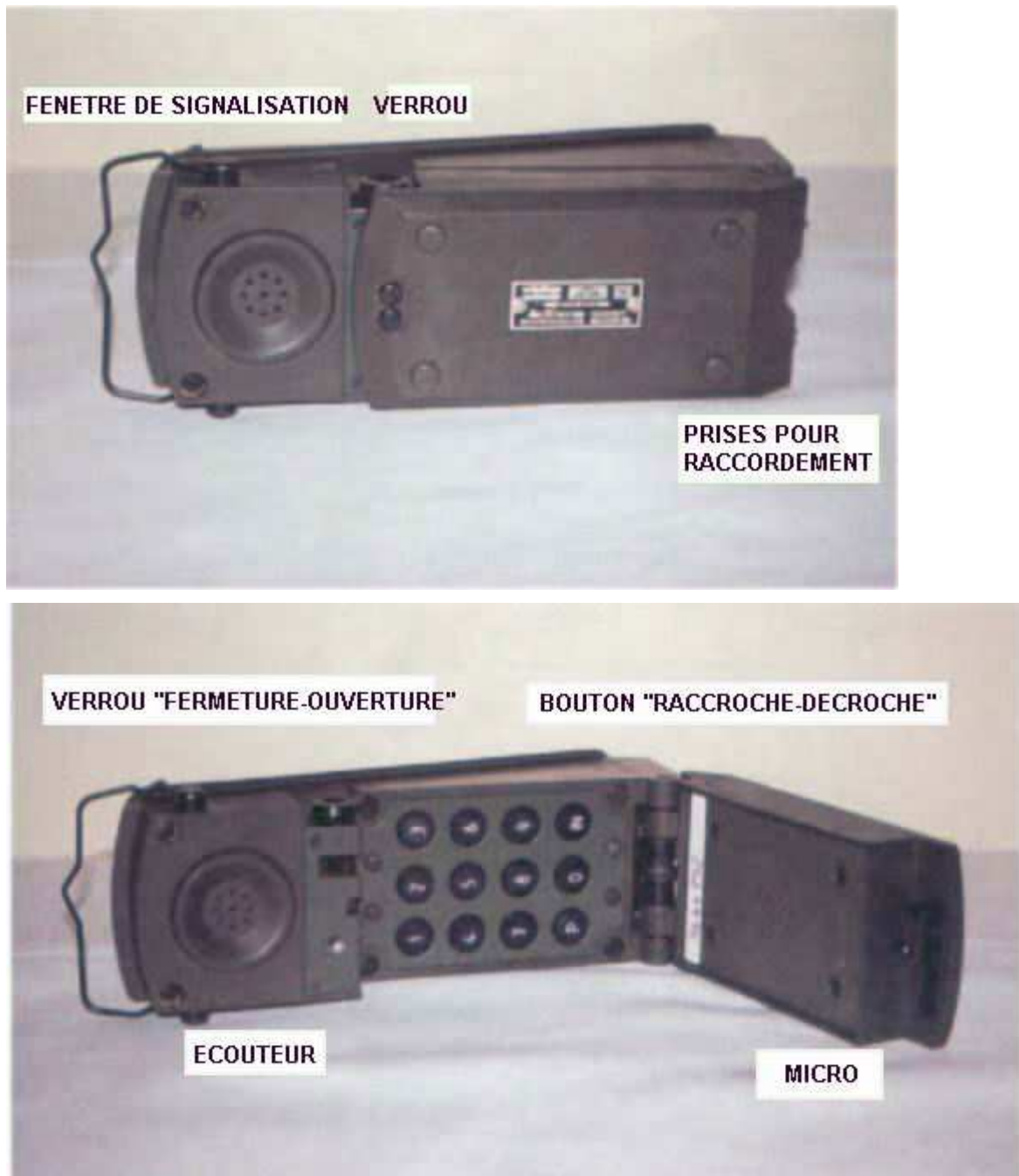
Figure 2. Le poste téléphonique d'abonné AT 35
