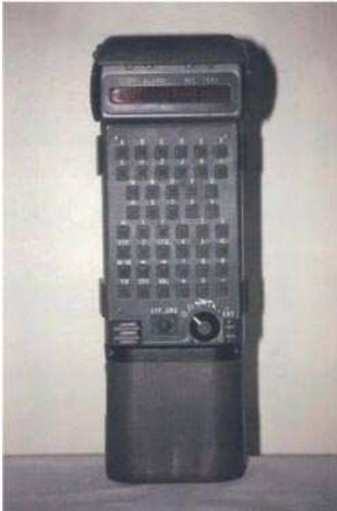
Figure 2. Le terminal tactique QR PM 1AM (TRC 743) « TERMIT »
