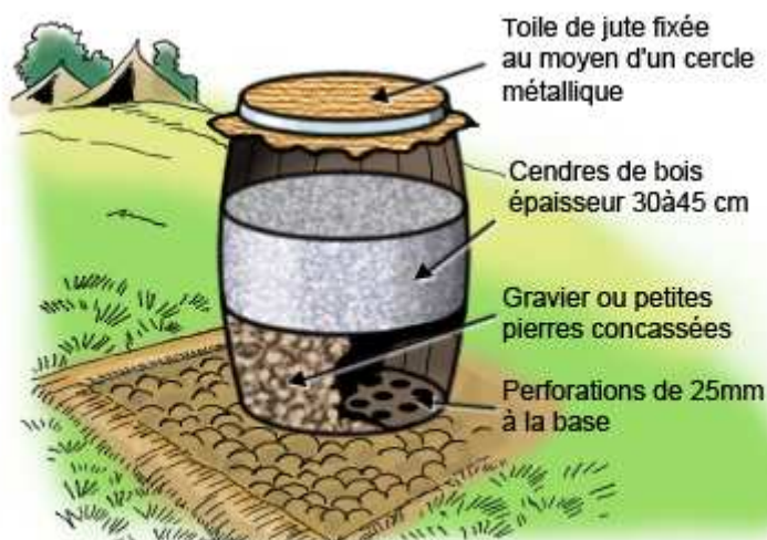
Fig 4. - Tonneau séparateur de graisse garni de cendres
