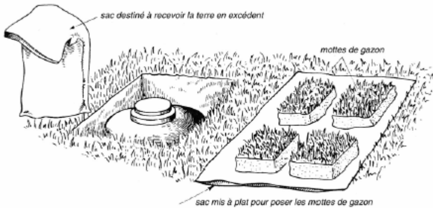
Fig. 3. - Camouflage d'une mine sous du gazon (cas général)
