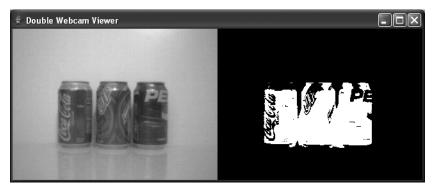
Figure 6-11. Threshold image: 0 min, 127 max
