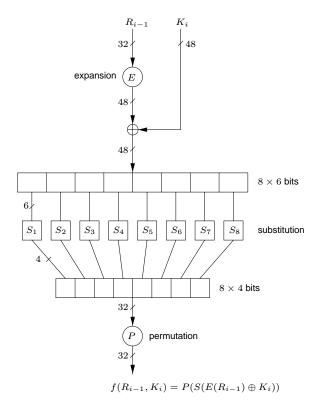
**Figure 7.10:** DES inner function f.
