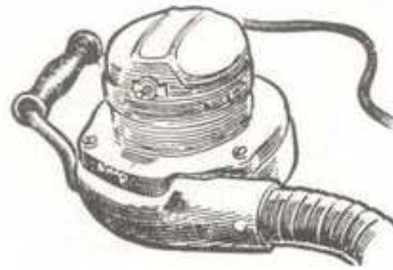
Fig. 9. Ex Air Ministry, 230 volt blower.
