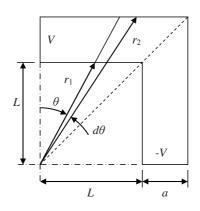
Fig. 3.6 Approximate equipotential surfaces
