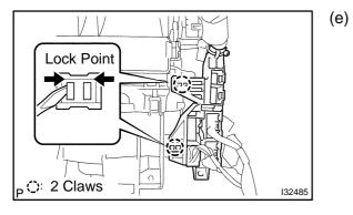
(d) Connect the connector to the blower w/ fan motor subassy.
