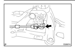
(d) Connect the end of the shift cable to the shift lever assy.
