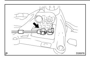
(d) Connect the end of the select cable to the shift lever assy.
