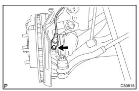
(d) Remove the bolt and speed sensor front LH.
