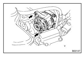
(d) Remove the 2 bolts and alternator.
