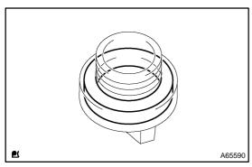
76. INSTALL OIL FILLER CAP GASKET
