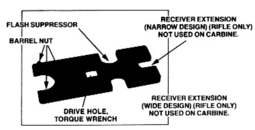
FIGURE A2. COMBINATION WRENCH (P/N 62696) (SEE FIG'S 3-2C, PAGE 21, 3-2P, PAGE 22 and 3-2Q, PAGE 23)
