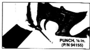
F. TRIGGER GUARD ROLL PIN REMOVAL
