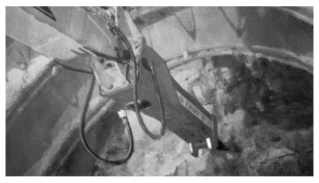
Fig. 4.11. Hydraulic hammer<sup>6</sup>
