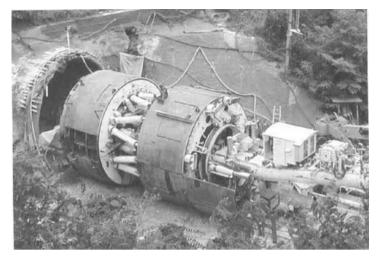
Fig. 4.28. Double shield<sup>27</sup>
