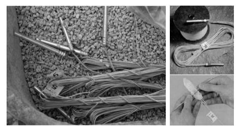
Fig. 4.17. Detonators
