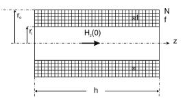
Fig. 10.9. Multiturn solenoid
