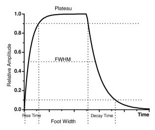
Fig. 1.1. Pulse shape parameters
